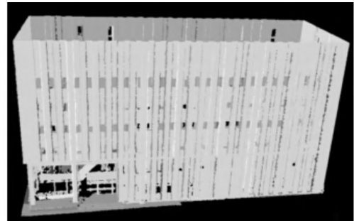
图 8 面片分割后验证大楼点云显示
